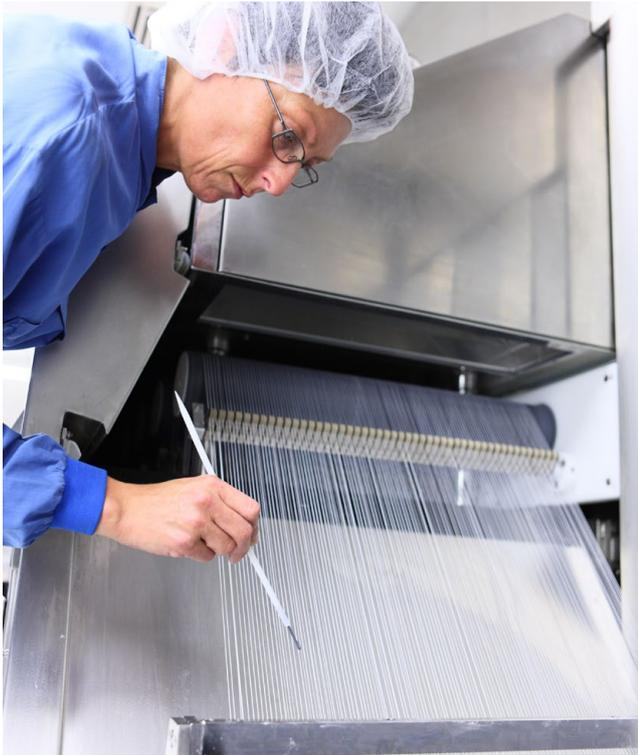
Abbildung 2: Produktion von Dialysemembranen
